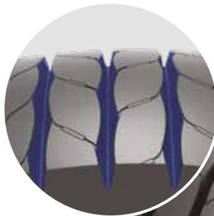
La geometría del diseño del dibujo en banda de rodadura optimiza la huella de pisada uniforme para una mayor **eficacia de frenado en mojado** y **drenaje del agua**.
