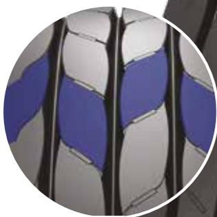
El hombro en banda de rodadura favorece la **resistencia al desgarro**, a las laceraciones y al **deslizamiento lateral**.
