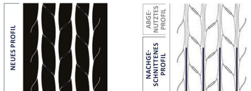
Maximale Nachschneide-Tiefe: 3mm • Maximale Nachschneide-Breite: 8mm
