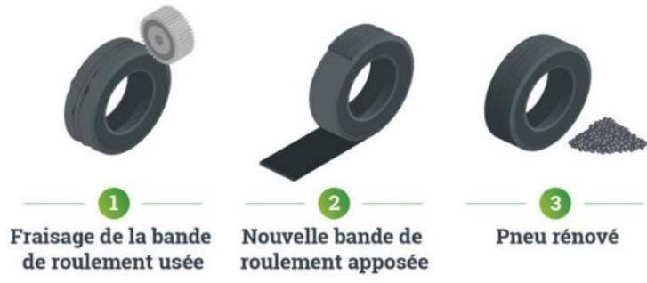
☑ Réparation par renouvellement de la bande de roulement. La bande de roulement fraisée est recyclée.
